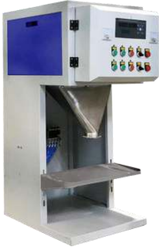
BELTA MD รุ่นโครงสร้างเหล็ก ส่วนสัมผัสวัสดุติดเป็นสแตนเลส
