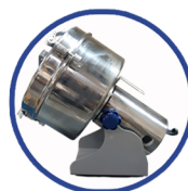
เครื่องสามารถ เอียงได้ 18° เพื่อการถ่ายเทวัตถุดิบได้ง่ายขึ้น
